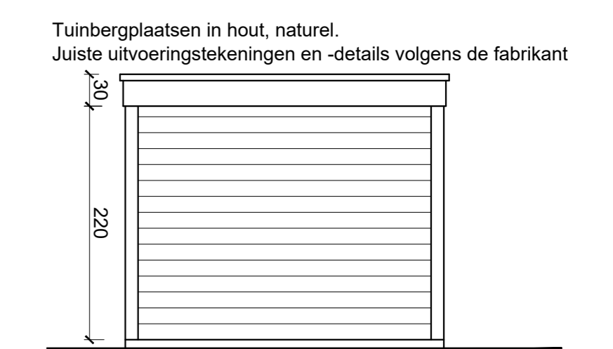
Tuinbergplaat: zijgevel rechts
